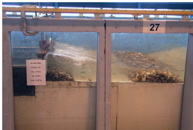
Figure 4 - Vague maximale heurtant le profil singulier muni d'un dispositif pare-houle incurvé (test de sensibilité pour une condition de niveau de Gironde supérieur à la CMS de 0.9 m)
